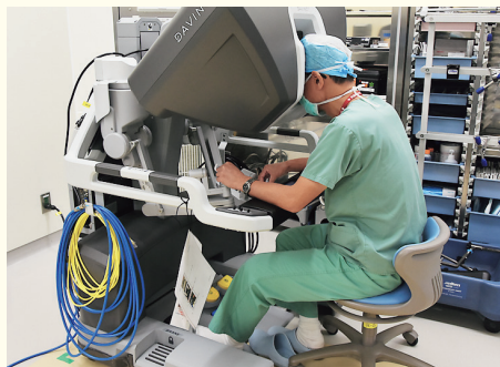
サージョンコンソール (術者が実際の手術操作を行うコックピットのような機器)
